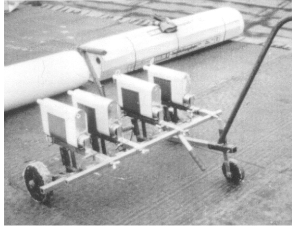
Figure 13 – Chariot d'application de la colle alwitra PUR D
